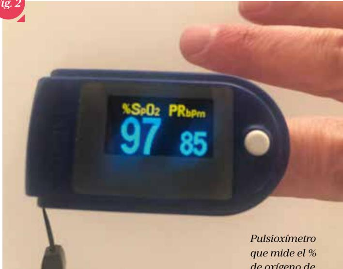
*Pulsioxímetro que mide el % de oxígeno de la hemoglobina en sangre con ayuda de métodos fotoeléctricos. Cuando aparece insuficiencia cardíaca con edema (líquido) en los pulmones, el oxígeno en sangre baja, siendo preocupante cuando desciende del 90%.*
